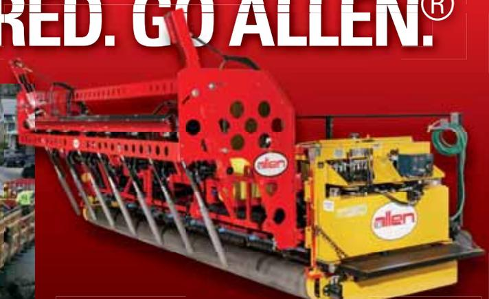
**TRIPLE ROLLER TUBE PAVERS WITH GANG VIBRATION**
